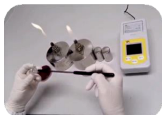
Подготовка бактериальной суспензии с использованием турбидиметра DL-ZD3
